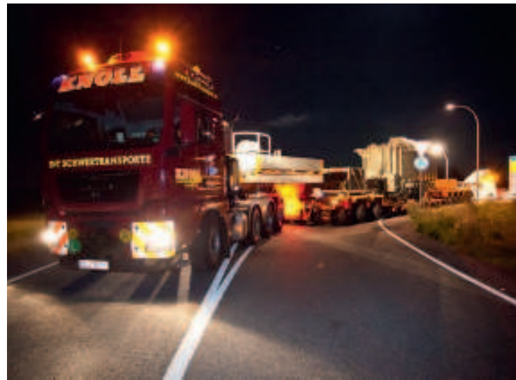
Mit einem Schwerlasttransporter wird im September 2011 ein neuer 110/20-kV-Transformator ins Umspannwerk Neuhaus gebracht
