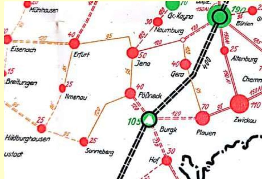
**Spitzenstrom der Saale-WKA: überregionale Nutzung -> Einspeisung in Reichsschiene (1941 realisiert!)**
