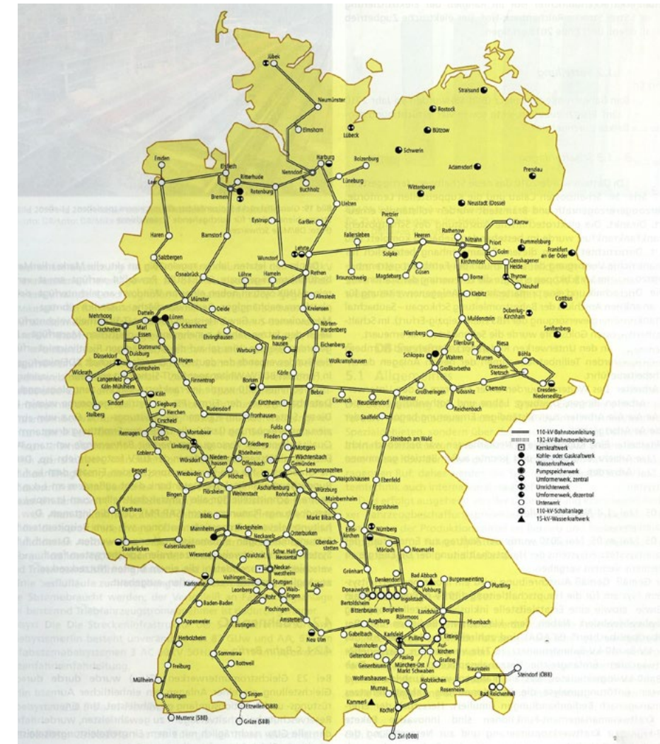
Bild 12: Bahnstromnetz, Erzeuger-, Übertragungs- und Verteileranlagen
