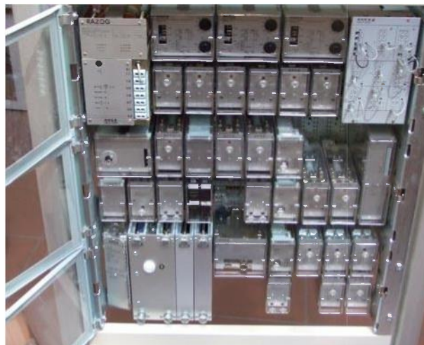
Bild 6: Erstes Distanzrelais mit polygonaler Kennlinie, RAZOG, ASEA
